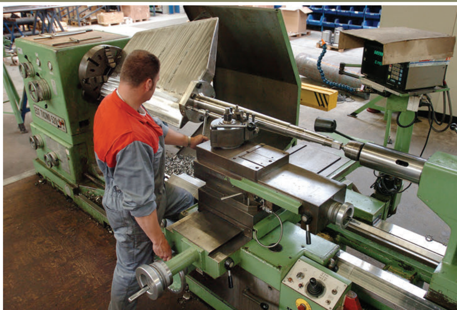
Werk in uitvoering: een maatwerk roerinstallatie in onze werkplaats in Hardinxveld
