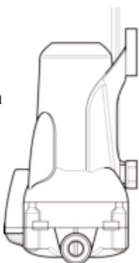
Fig 2 - Orientamento raccomandato per il montaggio della pompa
