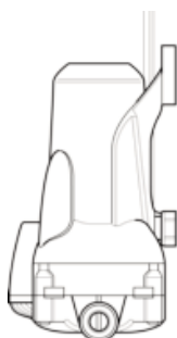
Fig 2 - Orientación de montaje de la bomba recomendada
