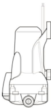
Fig 2 - Orientation recommandée du montage de la pompe
